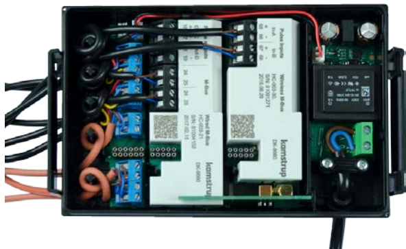
Wireless M-Bus-modul med intern antenne
